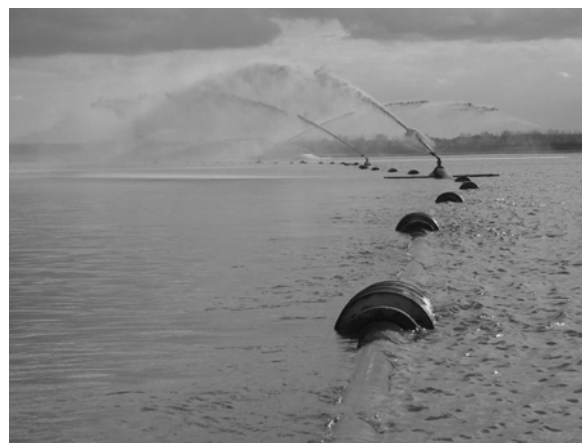
Abb. 4: Suspensionsverteilung im Koschener See mit Kreisregnern (Foto: BTU Cottbus).
